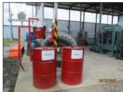
รูปที่ 2-16 การจัดเตรียมถาดรองรับน้ำมัน (Drip Tray) พร้อมวัสดุดูดซับ บริเวณเครื่องจักรที่ต้องเติมน้ำมัน
