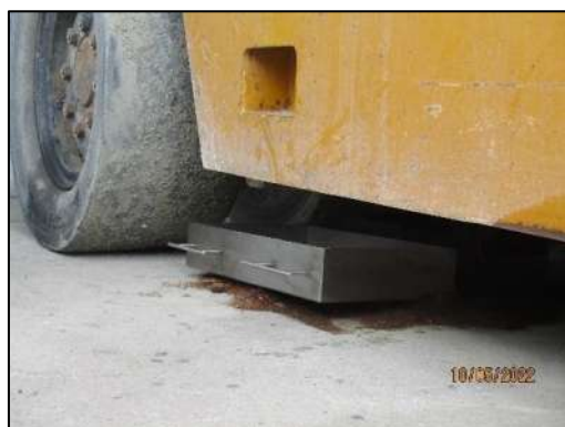
รูปที่ 2-16 การจัดเตรียมถาดรองรับน้ำมัน (Drip Tray) พร้อมวัสดุดูดซับ บริเวณเครื่องจักรที่ต้องเติมน้ำมัน
